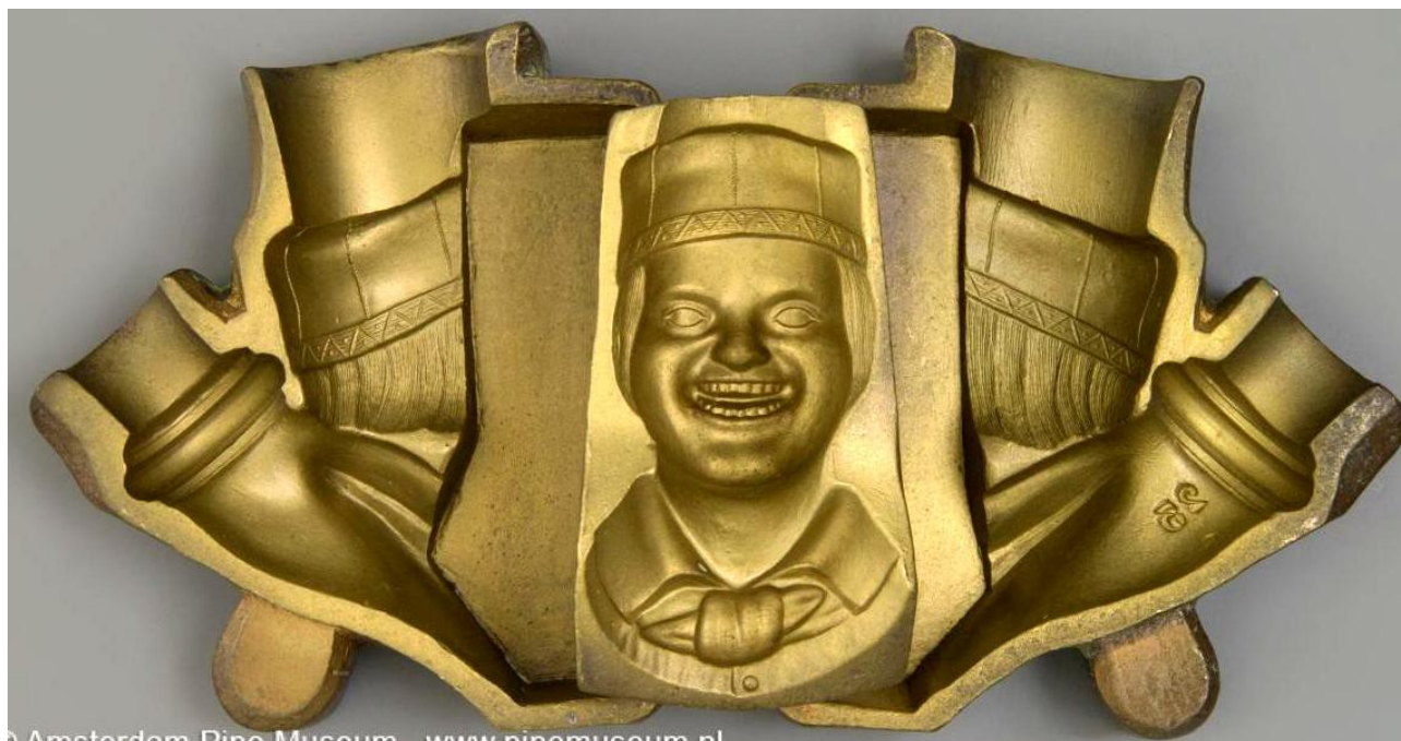
"Le Rieur" variations d'émaillage des têtes et le moule en cuivre. Collections Amsterdam Pipe Museum.
