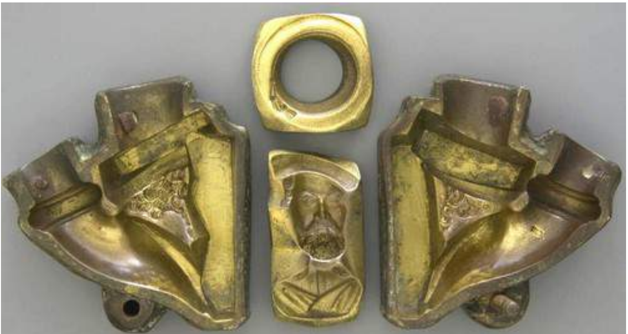
Moule en cuivre à façonner les "Chibouque". Collections Amsterdam Pipe Museum.
