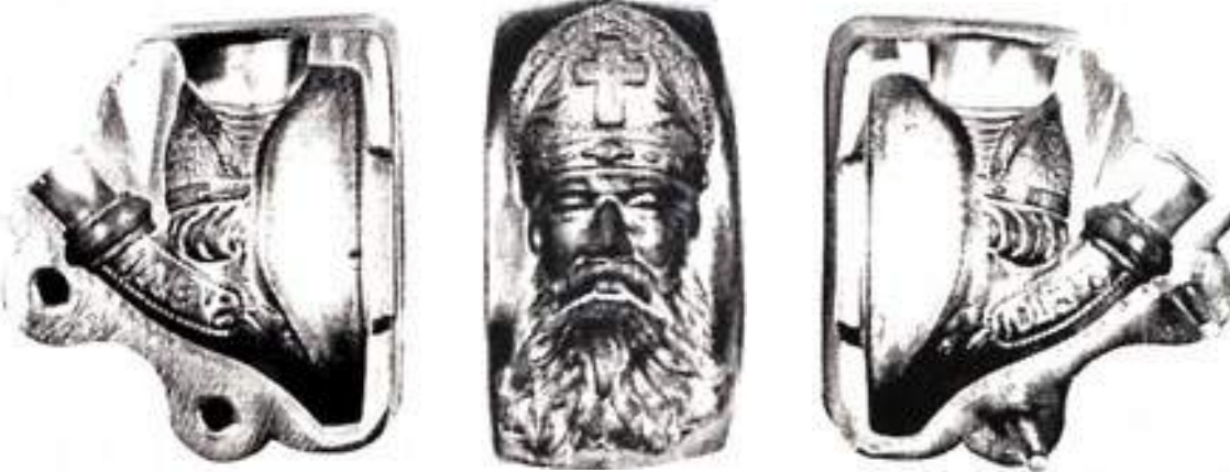
"Saint-Eloi" moule en cuivre en trois parties. Collections Musée de la Vie Wallonne à Liège.
